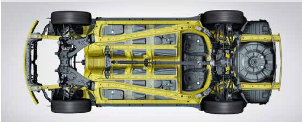
Усиленный каркас кольцеобразной формы
