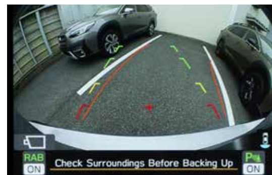
Камера заднего вида с омывателем и динамической разметкой
